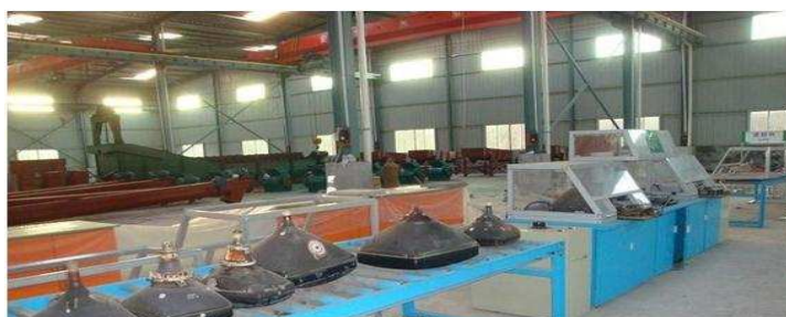
FIGURA 4 - Reciclagem de tubos de monitores de tubo.
